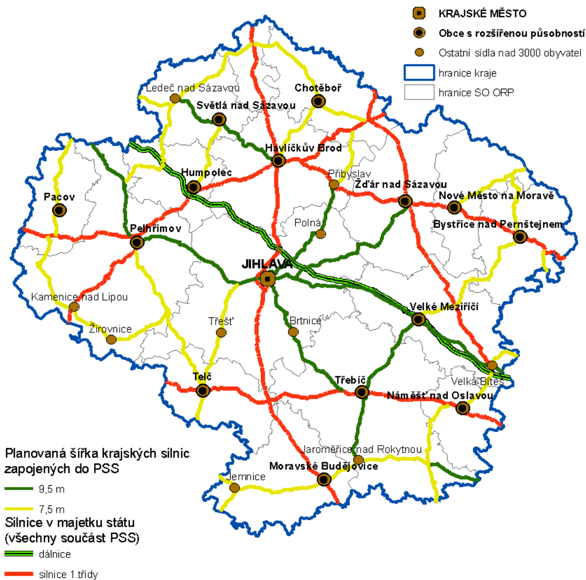
Obrázek 20: Páteří silniční síť Kraje Vysočina včetně plánovaného šířkového uspořádání krajských silnic.
